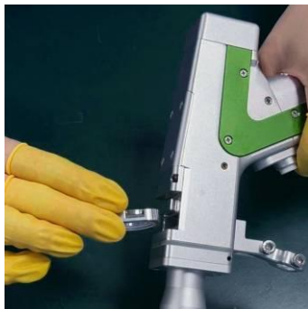
③將清潔後或更換的保護鏡片裝回保護鏡座，並裝回槍組
